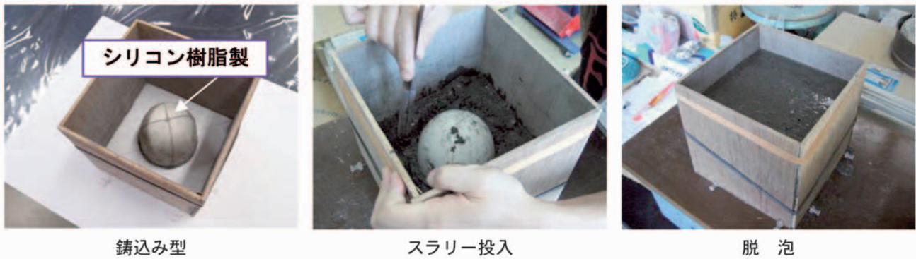
図2 凹み付きブロックの作製工程
