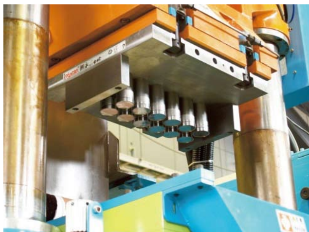
図3 大型油圧プレス機に取り付けた12個取り金型
