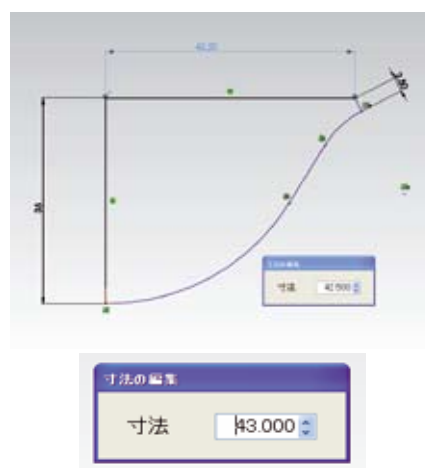
図15 専用ダイアログで寸法を拘束
