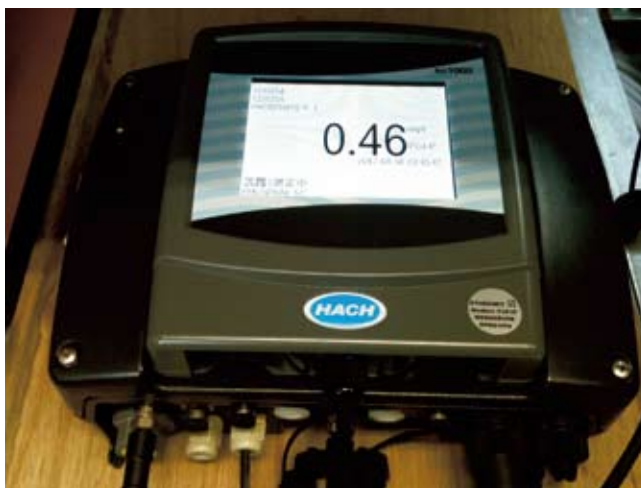
図5 リン吸脱着システム外観 (自動リン酸イオン濃度測定装置)
