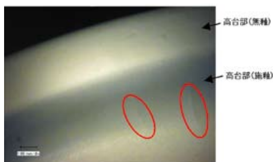
図6 1200℃焼成品の高台部分の亀裂 (赤丸で示した箇所)
