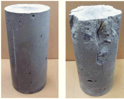
図8 フライアッシュ系ジオポリマーコンクリート(左)と圧縮試験後(右)の様子の一例 配合組成：単位水量=190kg/m 3 , 硬化液/FA=0.7
